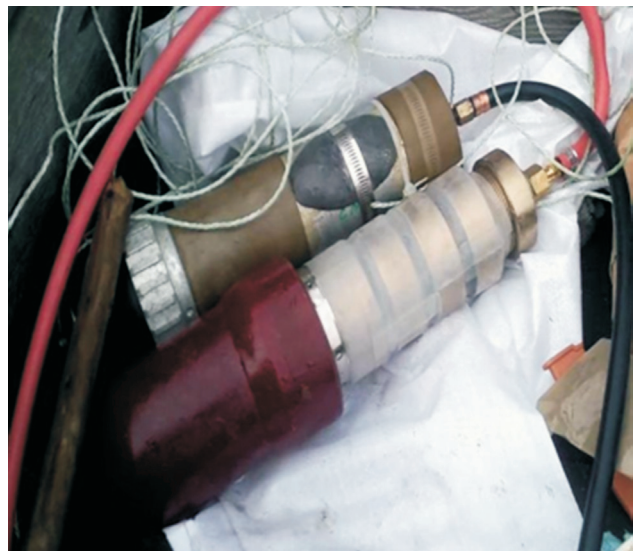
Рис. 3. Комплект пневмоизлучателей ПАС. А: ПИ «Лосось»; Б: ПИ «Дельфин»; В: ПИ «Косатка»; Г: «Пневмо-пушка» (вверху) Fig. 3. System of pneumatic emitters (PES). A: “Losos”; Б: “Delphin”; В: “Kosatka”; Г: “Pnevmopushka” (upper)
