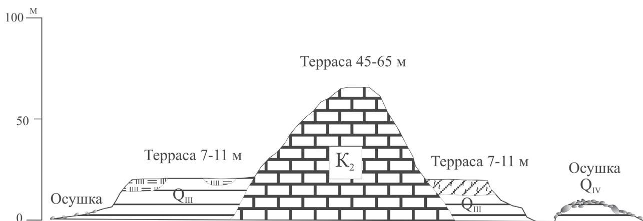
Рис. 5. Схематический геолого-геоморфологический профиль между речьями нижнего течения Пенжины и Таловки. Условные обозначения — как в рис. 3
